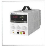
Netzgerät Maße: 130x155x295 mm Gewicht: 4,95 kg
